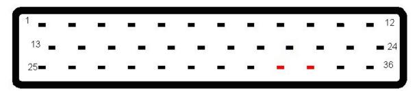
33 Serial O/P Txd 34 Serial I/O GND
