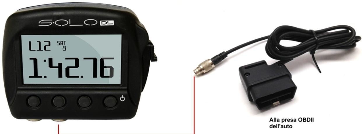
**Nota:** la resistenza di terminazione CAN è integrata nel cavo mentre la resistenza di pull-up per la linea K è integrata in SoloDL.
