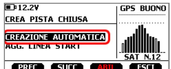
Solo2/Solo2DL crea automaticamente un tracciato e, una volta terminata la sessione, ne mostra la mappa; la linea del traguardo può essere riposizionata e può essere modificato il nome del tracciato, utilizzando la tastiera dello strumento. Sarà possibile trasmettere la pista al PC e, tramite Race Studio 3, modificarne i dettagli.
