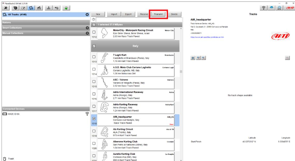
Premendo il tasto "Transmit" (riquadro rosso; immagine sopra), la nuova pista sarà trasmessa al dispositivo, rendendo possibile la scansione di ciascun tempo sul giro.
